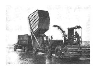
Abb. 9: Selbstfahrender Mähfeldhäcksler mit hydraulisch kippbarem Bunker.
