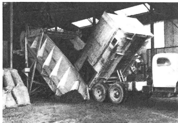
Abb. 10: Das mit selbstfahrenden Mähfeldhäckslern gemähte Erntegut wird auf Lastwagen umgeladen und in die Grastrocknungsanlage geführt.
