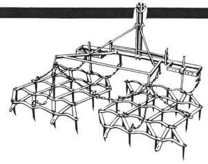
Ackereggen mit gehärteten und einzeln auswechselbaren Zinken. Kräftiger Zugrahmen mit verstellbaren Spurlockerern. Arbeitsbreite 210 und 315 cm. Die beiden äußern Felder sind bei der dreiteiligen Ausführung für die Straßenfahrt aufklappbar.
