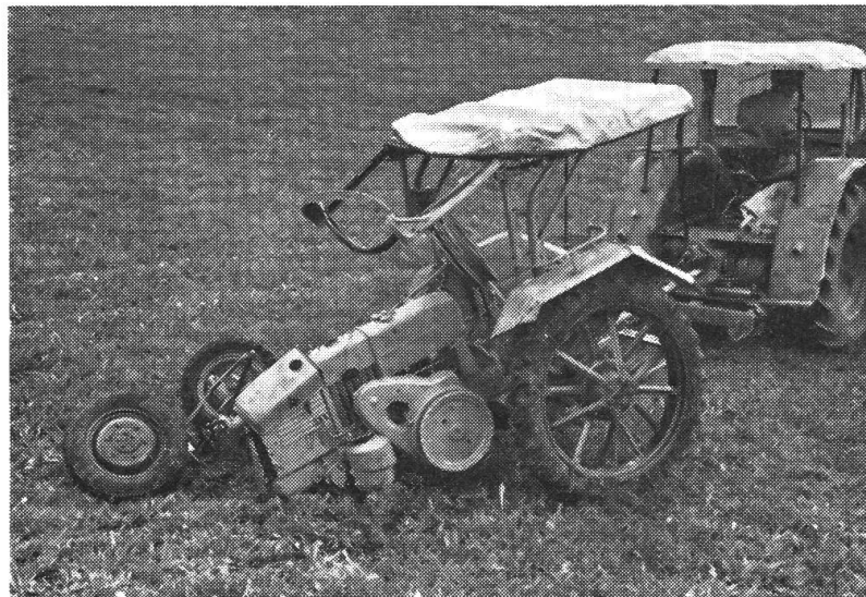
Abb. 5: Nach schwerem Sturz bleibt der Fahrerraum er- halten.
