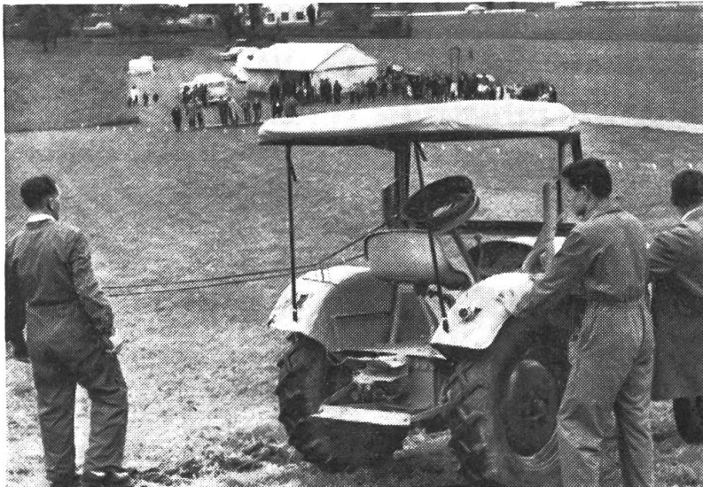
Abb. 6: Ueber eine aufgeschweisste Felge und Seilen werden die abgelassenen Traktoren gelenkt.
