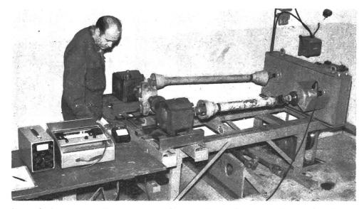
Dauerbelastungsprüfung rotierender Bautei'e (hier von Kreuzgelenken).
