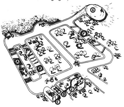
Beispiel einer kombinierten Anlage für Prüfstreckenerprobungen (USA): A Hindernisbahn 1 — B Grobe Pflasterstrasse — C Staubtunnel — D Wasserbad — E Morast — F Hindernisbahn 2 — G Schräghang.
