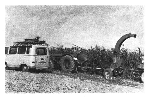
Das Betriebsbelastungsspektrum eines Feldhäckslers im praktischen Einsatz wird mit Hilfe elektronischer Messinstrumente über Klassiergerät oder Direktschreiber ermittelt.
