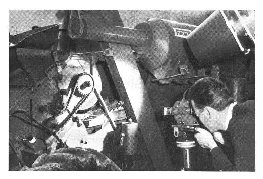
Erfassung eines Mähdreschvorganges mit einer Zeitdehnerkamera: Für einen Vorgang von 2 sec Dauer läuft der Film auf der Leinwand in 3 min. ab. Der Dreschvorgang lässt sich genau verfolgen, der Bewegungsablauf der ausgedroschenen Körner, des Lang- und Kurzstrohs usw.
