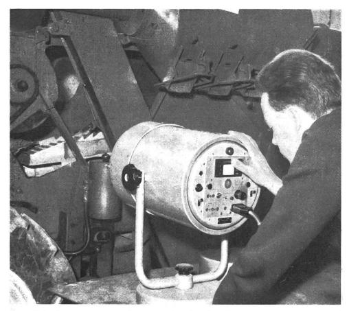
Für Schwingungsuntersuchungen (z. B. für Bewegungsvorgänge auf einem Mähdrescher-Strohschüttler) lässt sich das Lichtblitz-Stroboskop einsetzen.
