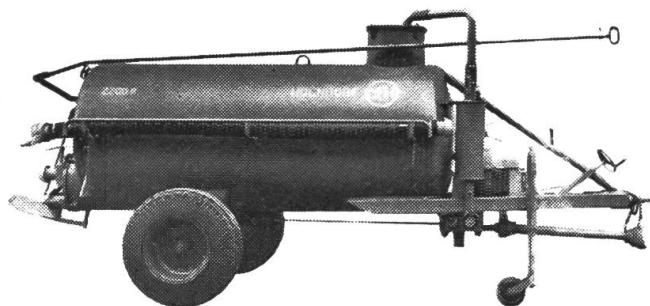
mit sehr leistungsfähiger Kompressor-Vakuumpumpe
