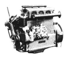
Wir stellen nicht nur weiterhin Schlepperdieselmotoren her wie bisher, sondern haben auch noch zusätzlich für diesen Zweck eine neue luft- und wassergekühlte, von 15 bis 115 PS reichende Baureihe von leichten kompakten Dieselmotoren (Drehzahl 2000 — 3000 U/min) herausgebracht, die gleiche Anschlußmaße und Hauptersatzteile unabhängig von der Kühlungsart aufweist. Planen Sie für die Zukunft, planen Sie mit MWM.
