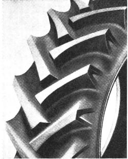
Abb. 13c: Neue offene Profilierung
