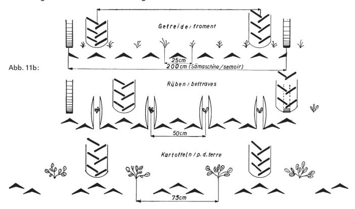
Die Einstellung der Spurbreiten erfolgt durch Umdrehen der Radscheiben und Verstellen der Felgen. An deutschen Traktoren mit 125 cm-Spur ist auch das Einlegen von Zwischenscheiben üblich.
