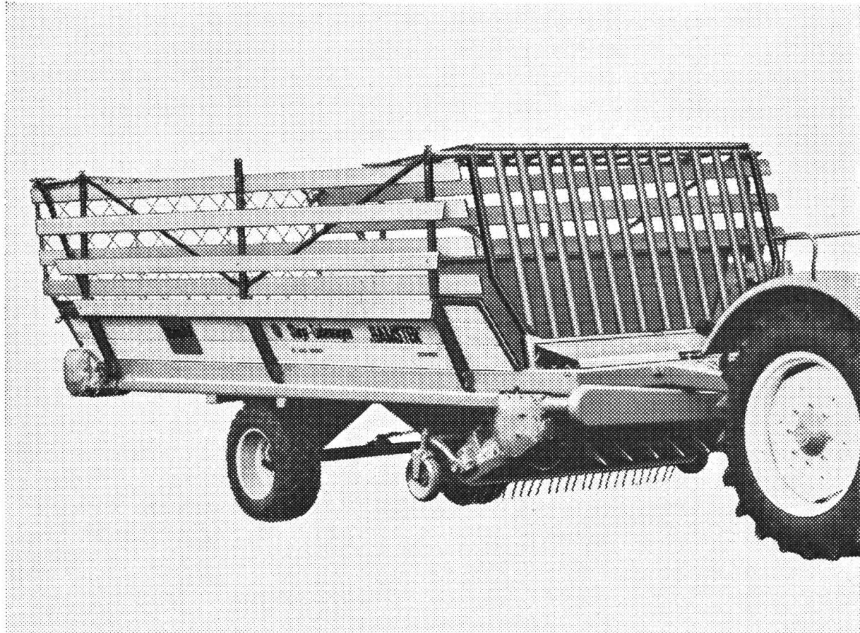
Einzigartig in bezug auf System, Konstruktion und Arbeitsweise. Sie müssen ihn gesehen haben! Gesamthöhe 2,80 m, in wenigen Minuten von 1 Mann abklappbar auf 2,10 m – Oelbadgetriebe – motorischer Pick-Up-Aufzug mit automatischer Sicherung – je nach Bedarf lose oder gepresst
