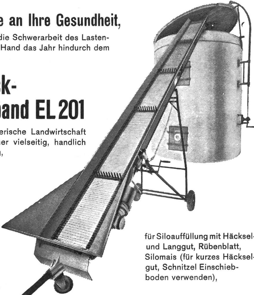
für Siloauffüllung mit Häcksel- und Langgut, Rübenblatt, Silomais (für kurzes Häckselgut, Schnitzel Einschiebboden verwenden),
