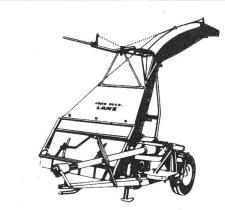
Schlegelfeldhäcksler FL 110 und FL 140 garantieren ein sauberes «Mähen» und Einbringen des Erntegutes. Arbeitsbreiten 100 bzw. 140 cm
