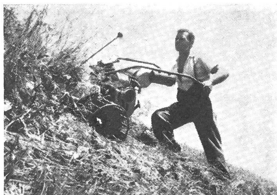
Abb. 6a: Motormäher am Steilhang, ausgerüstet mit speziellen Zusatz-Gitterrädern
