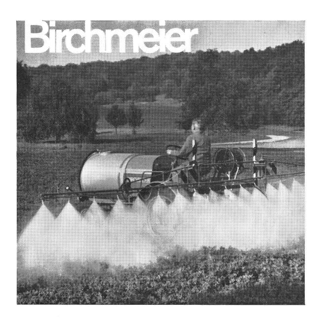
BIMOTRA S VI Die zuverlässige, selbstfahrende 4-Rad-Hochdruck-Motorspritze. Pumpenleistung von 100/1/min bei 60 atm. 8 Vorwärts- und 4 Rückwärts-Gänge. VW 1500 Motor 34/43 PS oder MWM Diesel 27/30 PS. Ausführung aller Motor-, Pumpen- und Spritzbarren-Manipulationen vom erhöhten Führersitz aus.
