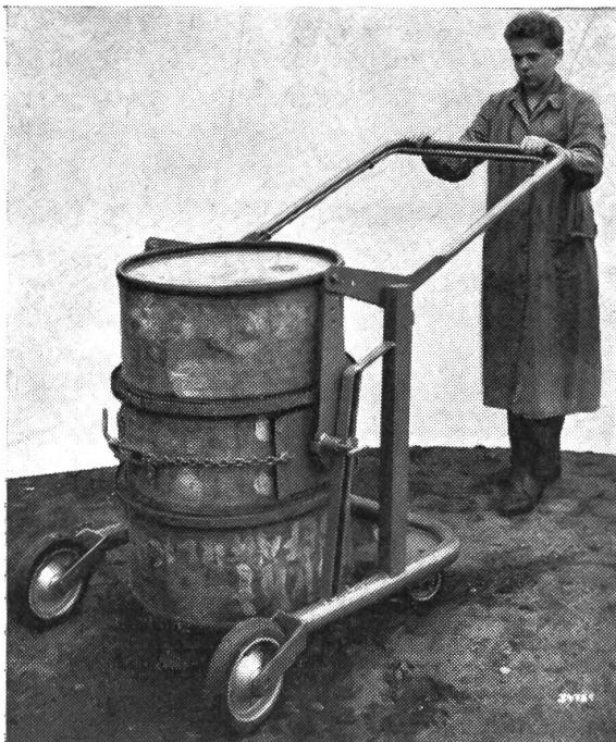
Will man das gefüllte Fass entleeren, zieht man den Sicherungsbolzen nach aussen und drückt das Fass leicht nach vorn (Abb. 2). In der horizontalen Lage rastet der Sicherungsbolzen von selbst wieder ein, und der Inhalt kann mühelos abgefüllt oder
