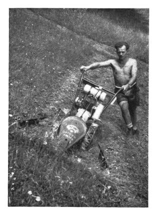
Abb. 3: Motormäher Nr. 4 bei der Arbeit mit einfachen Rädern
