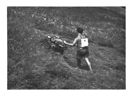
Abb. 1: Der Versuchsmann beim Mähen mit dem Motormäher und der Respirationsgasuhr
