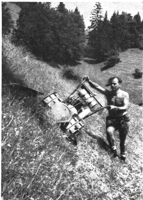
Abb. 4: Motormäher Nr. 4 mit Doppelrädern beim Mähen im Steilhang
