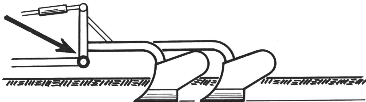
Fig. 7: Nach diesem Schema wurde der Pflug angehängt um die Furche nach Aufzeichnung 6 zu erstellen.
