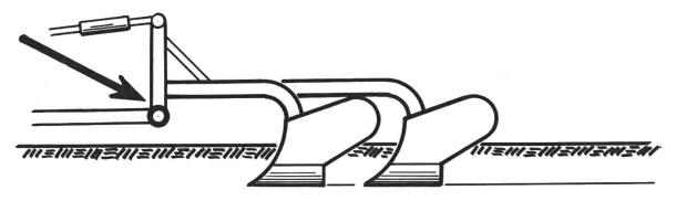
Fig. 7: Nach diesem Schema wurde der Pflug angehängt um die Furche nach Aufzeichnung 6 zu erstellen.
