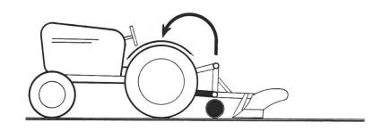
Später versuchte man, durch verschiedene Massnahmen, einen Teil des Pfluggewichtes auf die Traktorhinterräder zu verlegen. Zu diesem Zweck entlastete man den Pflug mit Hilfe der Hydraulik teilweise dauernd, teilweise aber nur über schwierige Stellen hinweg (Fig. 2). Es ist dies eine Art der Adhäsionsverbesserung die recht gute Ergebnisse zeitigte. Man beachte in diesem Zusammenhang die Aufzeichnung 3. Bei dem aufgezeichneten Versuch kam allerdings der «Contra-Schlupf» etwas zu gut weg,
