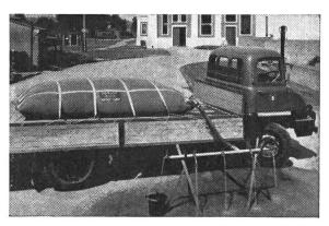
Die Spezialbehälter können mit einem Fassungsvermögen bis zu etwa 8000 Liter auf Lastkraftwagen, Unimogs oder Traktoranhängern transportiert werden. Interessant ist, dass man nicht an bestimmte Beförderungsmittel gebunden ist, da der Kautschukbehälter sich nach dem vorhandenen Transportmittel formt. Aber auch für stationäre Zwecke werden derartige Tanks produziert, und zwar mit einem Volumen bis zu 300 000 Liter.
