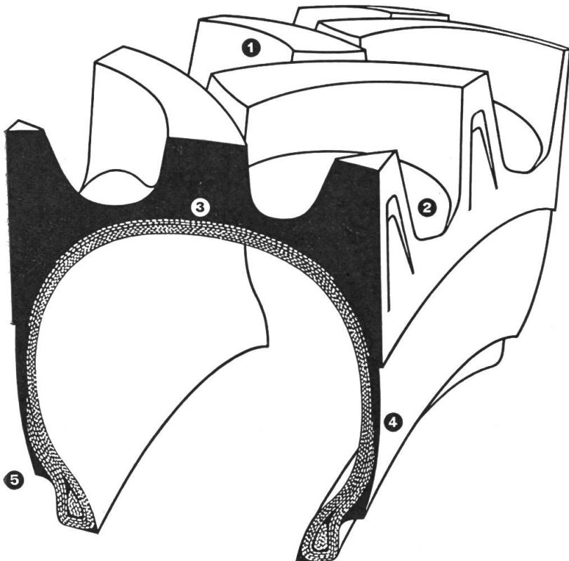
**1** Dasselbstreinigende Profil gewährleistet Griffigkeit auch in schwerem Gelände.
