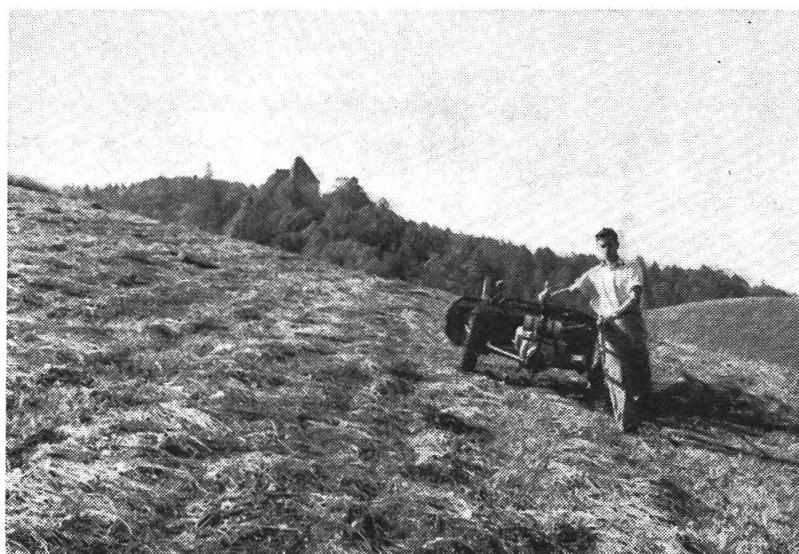
Abb. 8 und 9: Die Band- bzw. Kettenrechen werden gegenwärtig meistens als Anbaumaschinen für Motormäher und Einachstraktoren oder auch als Selbstfahrer angeboten.
