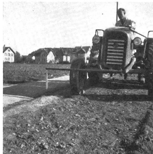
Abb. 3b: Der Front-Richtungsanzeiger ermöglicht gerades Fahren bei der ersten Runde
