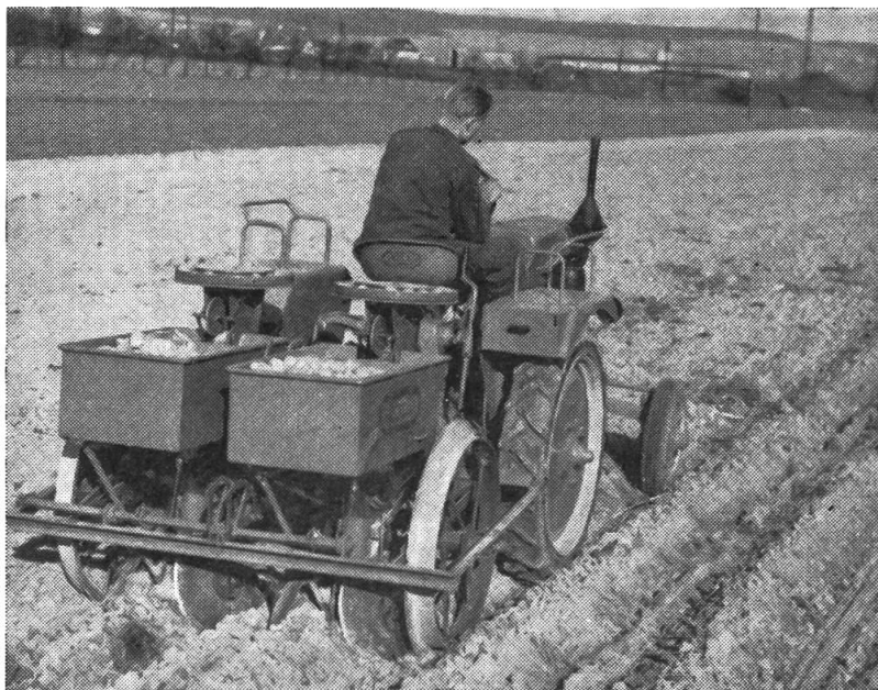
Abb. 15: 2-reihige vollautomatische Legemaschine mit Fehlstellenausgleichern (grosses Fächerrad für 19 Knollen und Tastrad) bei Einsatz im Einmannsystem (Kein Weg vorhanden!)
