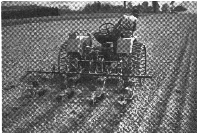
Abb. 6: Pflanzlochen 4-reihig unter Zuhilfenahme der Doppelbereifung (hier Gitterräder)
