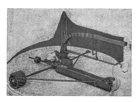
Abb. 8: Oberentnahme-Fräse
