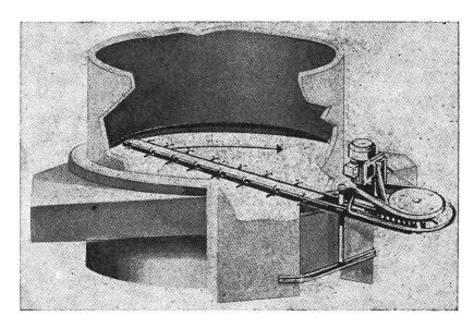
Abb. 4: Unterentnahme-Fräse
