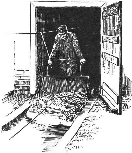
Abb. 5: Mistschieber mit Seilzug
