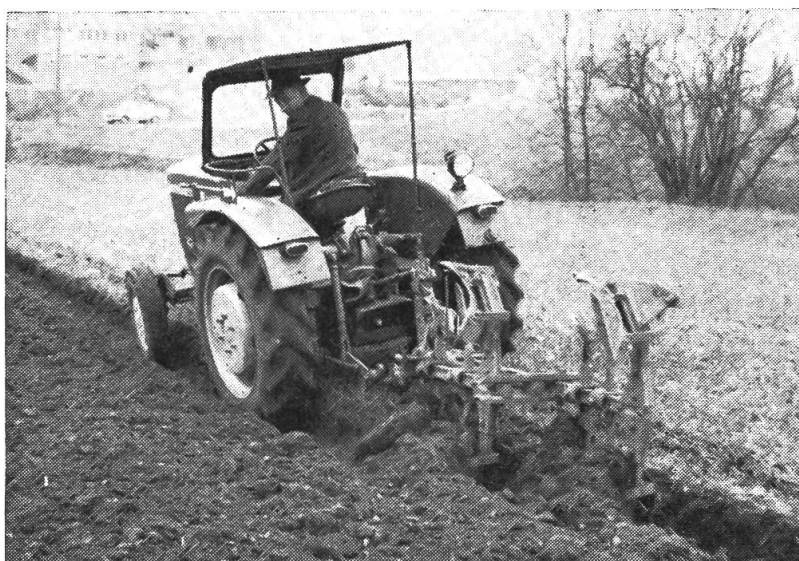
Abb. 1: Ein mit Regelhydraulik ausgerüsteter Traktor leistet mit einem geeigneten Zweischarpflug je nach Arbeitsverhältnissen 25 bis 35 a/h
