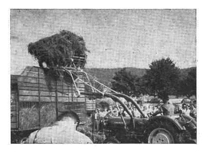
Abb. 5: Heckgreifer oder Siloschwanz für den Transport von Grünfutter.
