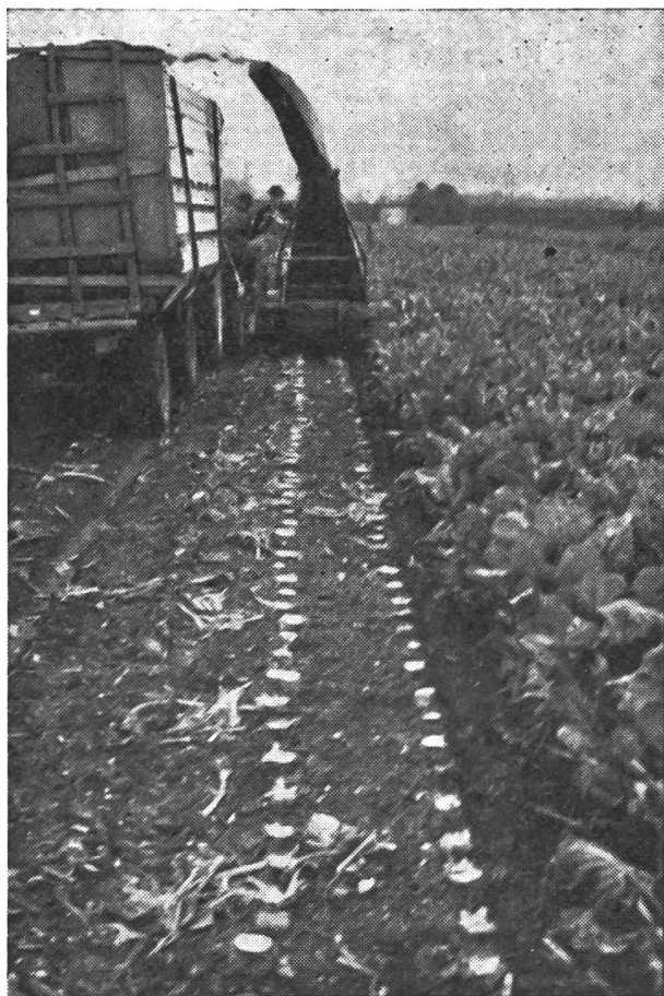
Abb. 3: Köpfen und Aufladen des Rüben- blattes mit dem Schlegelfeldhäcksler. Bei richtiger Einstellung und ebenem Feld können bis 70 % der Rüben ein- wandfrei geköpft werden.
