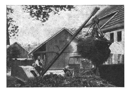
Abb. 11: Beladen des Mistzetters durch den fahrbaren Seilzug-Ladekran
