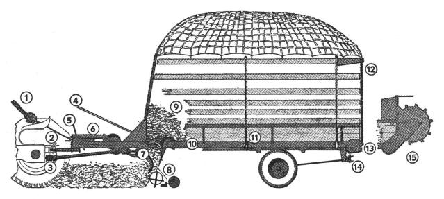
Abb. 7: Schema des Ladewagens mit Untenbeschickung.
