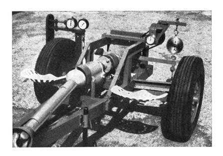
Das Leistungsmessgerät vom Traktor aus gesehen. Vorn auf dem Bild erkennt man die Gelenkwelle mit Schutz. Die Messinstrumente von links nach rechts sind: Das Messgerät für die Vorwärtsgeschwindigkeit, das Manometer zum Messen der Zugkraft, der Drehzahlmesser für die Zapfwellendrehzahl und die Federwaage zum Messen des Drehmomentes.
