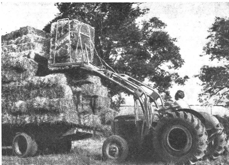
Abb. 8 und 9: Mit einem mit Klemm- armen oder Greifer- zinken ausgerüsteten Frontlader können ganze Ballenstapel auf einmal aufgeladen werden.
