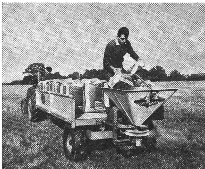
Abb. 4: Ein anderer Schleuder- Düngerstreuer aus Kunst- stoff. Die Streuscheibe wird mit Oel der Traktor- Hydraulikpumpe ange- trieben.
