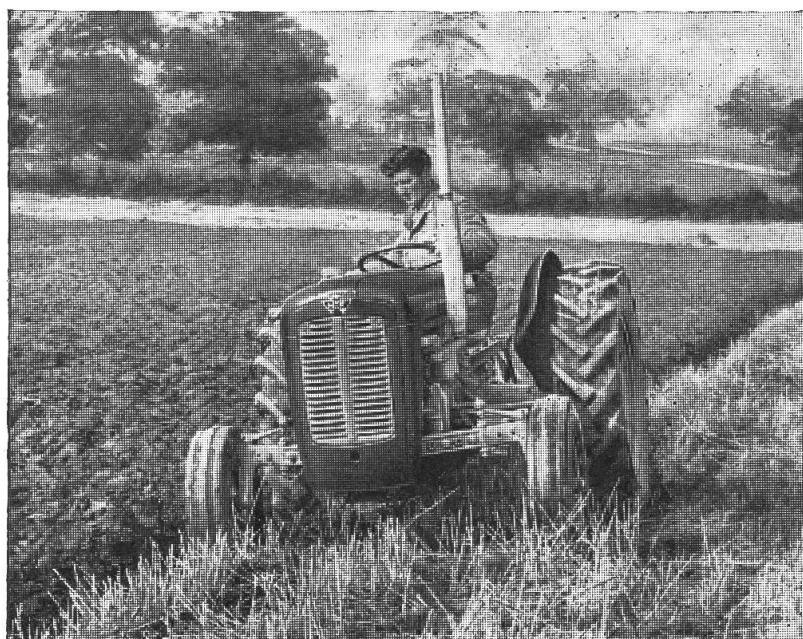
Abb. 14: Die Traktoren Massey- Ferguson werden neuer- dings serienmässig mit einer Differentialsperre ausgerüstet. Auf Wunsch kann auch ein hydraulisch schaltbares Untersetzungsgetriebe eingebaut werden.
