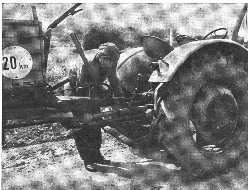
Abb. 11 Prüfen einer Gelenkwelle auf ihre Schubverhältnisse (Welle ist zu lang)
