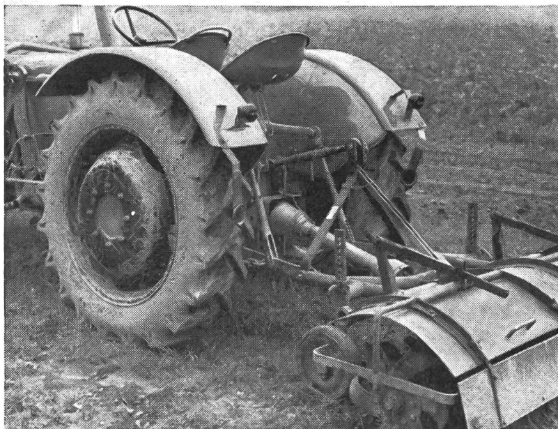
Abb. 12 Richtige Winkelstellung durch richtige Auf- hängung der Bodenfräse; Abwinkelung der Gelenke traktor- und geräteseitig gleich
