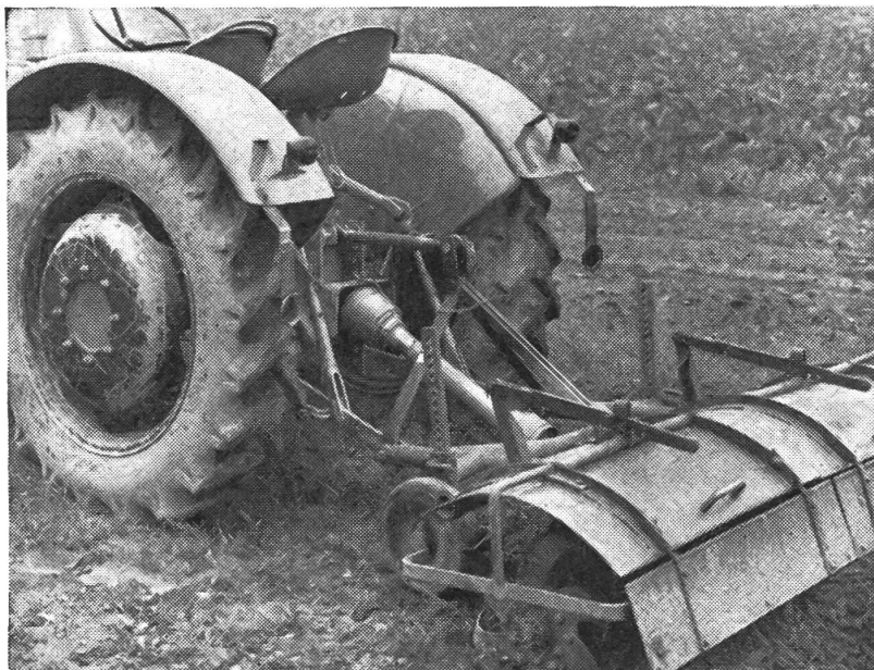
Abb. 13 Falsche Winkelstellung durch falsche Aufhängung der Bodenfräse; Abwinkelung des traktor- seitigen Gelenkes stärker als die des geräteseitigen Gelenkes
