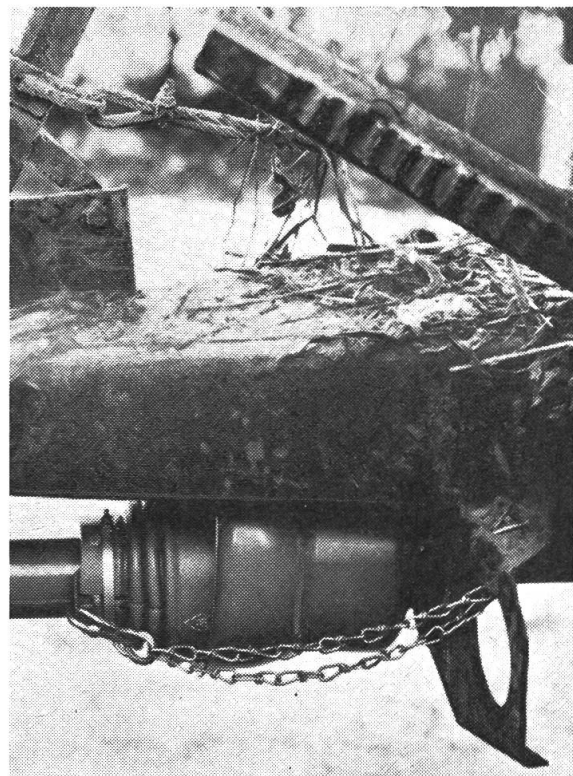
▲ Abb. 2: Besonders dann reißt die Kette, wenn zu der falschen Anhängung noch eine falsche Befestigung kommt.
