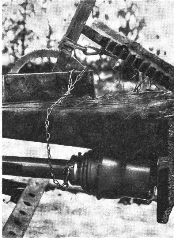
◄ Abb. 3: Die Kette wird derart um ein Maschinenteil geschlungen, dass sie in der Ruhestellung locker durchhängt.
