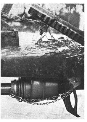
Besonders dann reisst die Kette, wenn zu der falschen Anhängung noch eine falsche Befestigung kommt. Die Kette wird in diesem Falle kurz um ein Maschinenteil geschlungen und mit der Oese in den Karabinerhaken eingehängt. Der Karabinerhaken schliesslich wird an der Lasche des Spannbandes am Schutztrichter befestigt (siehe Bild 2).
