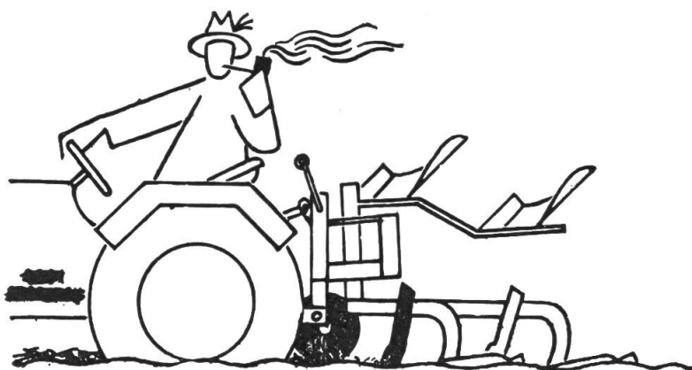
Abb. 4: Das Stützrad befindet sich möglichst nahe am Traktor, daher keine Ver- stopfungsgefahr durch einzupflügenden Mist.
