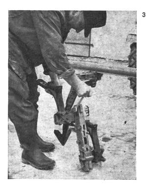
Abb. 1: Normalklaue mit Häufelkörper und in der linken Hand die neue Vielzweckklaue
