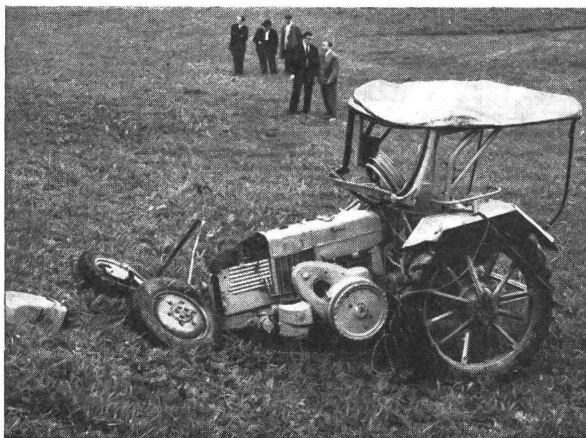
Abb. 4: Traktor mit Ueberschlagschutzbügel nach dem Absturz und mehrmaligem Ueberschlagen am Steilhang (ca. 80 %). Der Führerraum war nicht eingedrückt, hingegen wurde das vordere Fahrgestell abgerissen.
