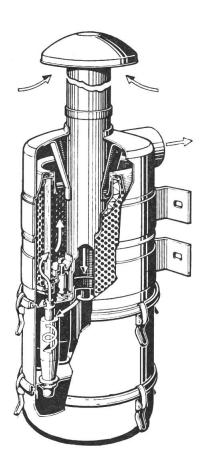
Der Kombinationsfilter «Pico-Zyklon». Im unteren Teil sind zahlreiche Zyklone im Kreis angeordnet, die den Großstaub ausscheiden. Die darüber eingebaute Papierpatrone «Micro-Top» übernimmt die Ausscheidung des Feinstaubes. Der Reinigungsgrad beträgt 99,50/0.
