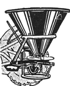
Eignet sich sehr gut für gekörnten Dünge. Arbeitsleistung: 6 ha pro Stunde. Säbreite 8 bis 12 m.
