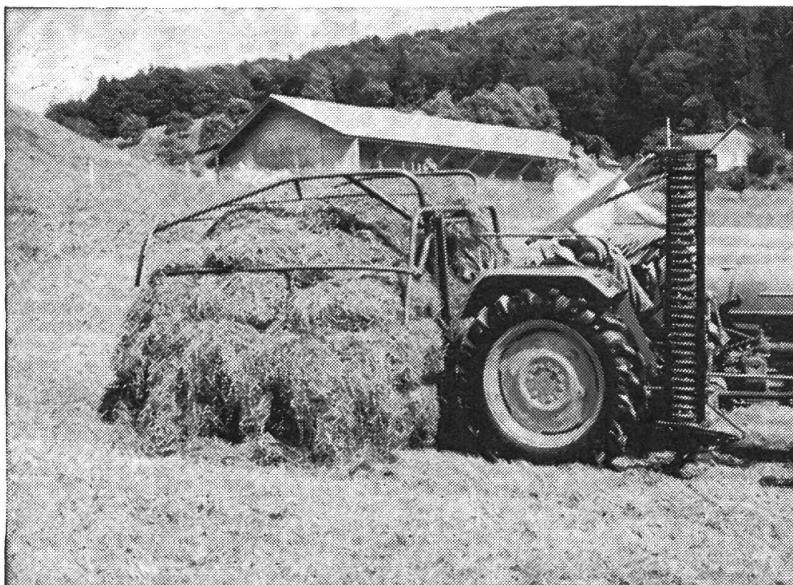
Abb. 9: Heuschwanz beim Anheben einer Ladung Halbheu. Das Gerät ist aber in erster Linie zum Aufnehmen und Transportieren von Dürrfutter geeignet, und vermag davon 250–350 kg zu fassen.
