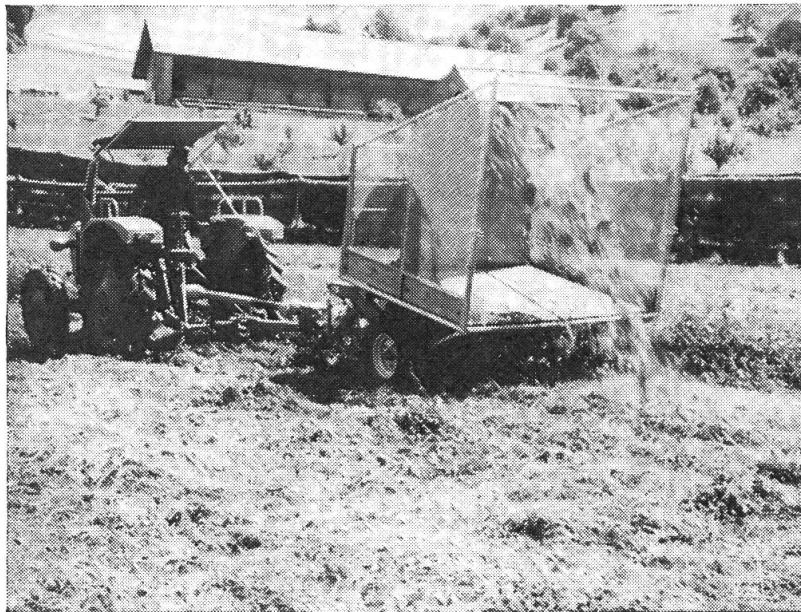
Abb. 2: Schlegelfeldhäcksler «Ernterotor» mit aufge- bautem Graskorb. Die hintere Wand des Korbes ist entfernt wor- den, da man nur mähen und das gequetschte Gras zum Trocknen ausbreiten wollte. Geschlossen ver- mag der Korb ca. 1000 kg Grünfutter zu fassen. Die Kombination stellt einen «Häckselselbstlade- wagen» dar.
