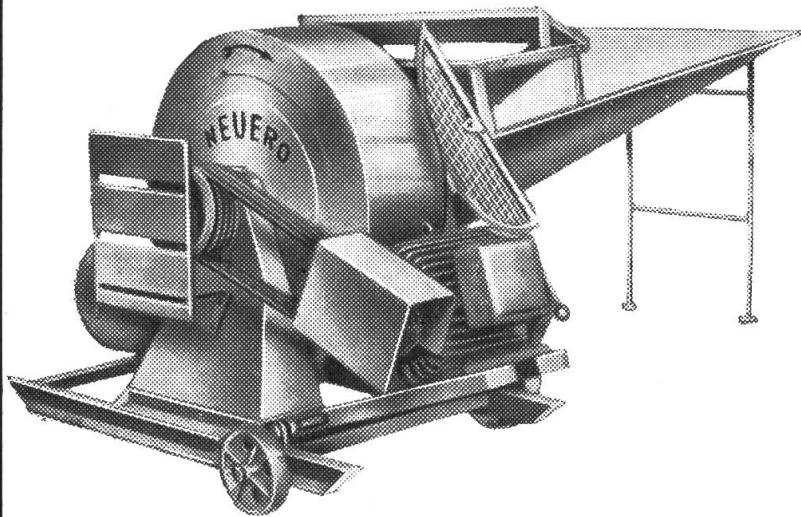
In Verbindung mit einem Förderband sind Neuero-Gebläseschneider besonders nützlich für Betriebe mit Feldhäckslern oder Ladewagen.
