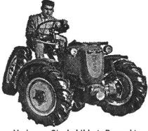
TEM mit Dreipunkt-Motor-Hydraulik = Vielzweck-Gelände-Traktor mit Allradantrieb. Maximale Zugkraft. Alle Anbaugeräte.
