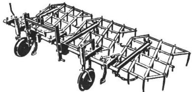
Ganzstahlkonstruktion mit langen gehärteten Zinken, schwere Ausführung.
