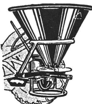
Eignet sich sehr gut für gekörnten Dünger. Arbeitsleistung: 6 ha pro Stunde. Säbreite 8 bis 12 m.
