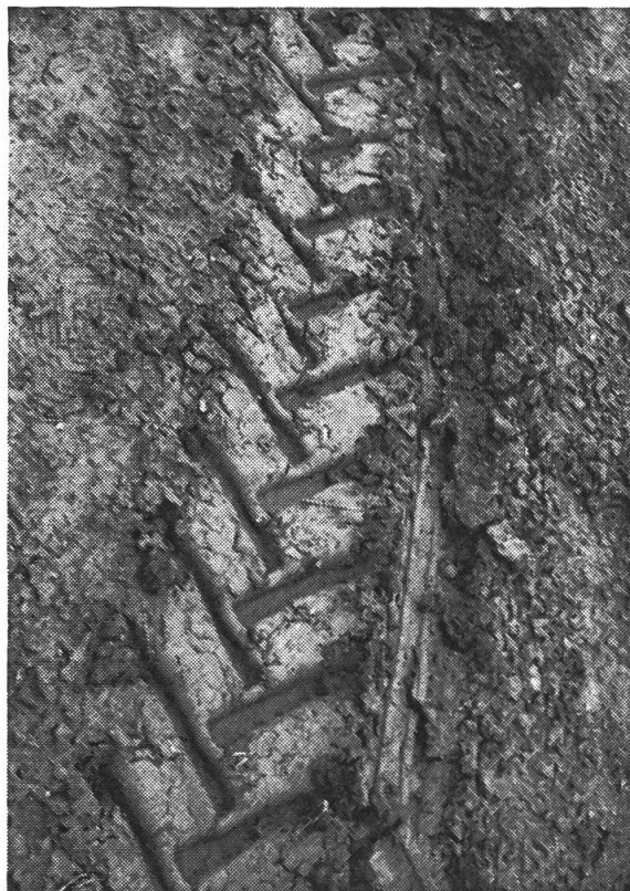
Abb. 3: Wenig Schlupf — deutlicher Profilabdruck sichtbar
