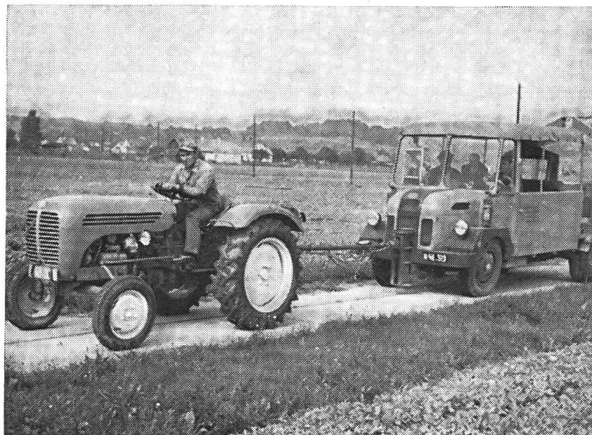
Abb. 1: Zugkraftmessung auf einer eigens dafür geschaffenen Betonbahn der Bundesversuchs- und Prüfungsanstalt für landw. Maschinen und Geräte in Wieselburg/Erlauf
