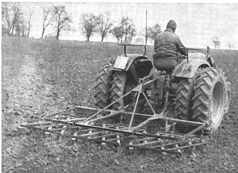
Abb. 6: Zwillingsbereifung: innere Bereifung 8-32" äussere Bereifung 10-28"
