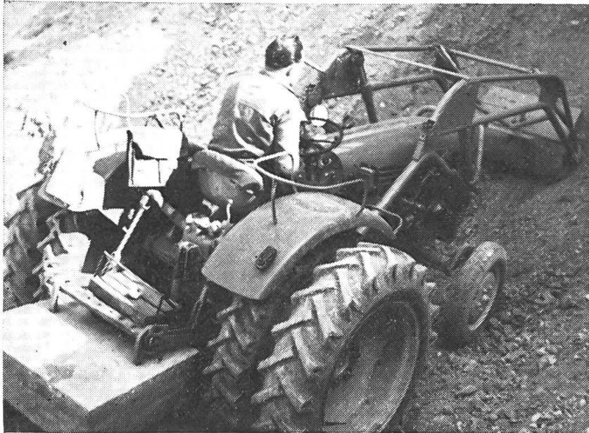
Abb. 5: Traktor mit Frontlader und Zwillingsbereifung beim Schotterladen
