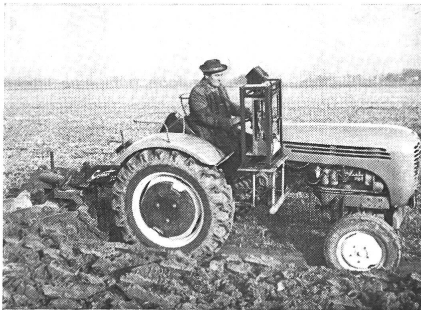
Abb. 7: Der Traktor mit auf- gebautem Messgerät während der Versuchsfahrten
