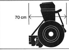
Als ausgesprochene Dreipunktmaschine ist sie sehr kurz gebaut: ihr Schwerpunkt liegt nur 30 cm hinter den Anschlusszapfen. Die Vorderräder des Traktors werden kaum entlastet und man darf deshalb die Maschine ungeachtet ihrer grossen Säbreite von 2,25 m bis 2,64 m auch an leichte Traktoren anbauen.
