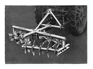
Die neue «Gruse»-Messer-Rollegge mit verstellbaren Messer-Wellen
