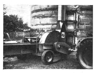
«Speiser-Presto» Hochleistungs-Abladegebläse für Zapfwellenantrieb mit Alt-Traktor.
