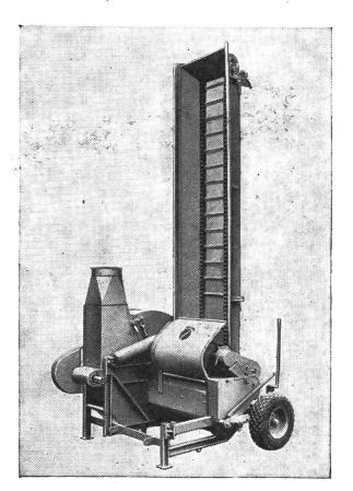
Der Zuführtrog kann hochgeklappt werden, damit ein unbehindertes Heranfahren der Fahrzeuge möglich ist.
