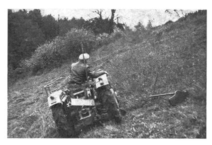
Abb. 5: Ein Leichttraktor mit tiefem Schwerpunkt und gut profilierten Reifen hielt sich am Hang gut.
