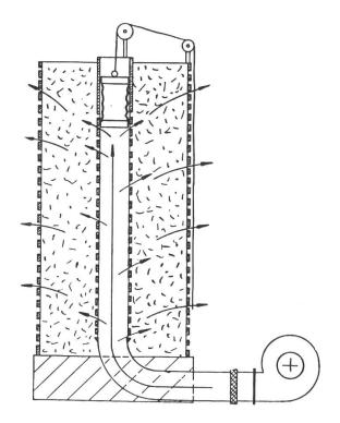
Der Zentralrohrsilo (Abb. 2) hat eine waagrechte (Querbelüftung) von innen nach aussen gerichtete Luftführung. Da der Silo höher gebaut werden kann, erhalten wir für die gleiche Getreidemenge eine bedeutend kleinere Grundfläche. Diese Bauweise ist teurer als beim Flachsilo; dafür ist aber die Entleerung bedeutend besser gelöst.
