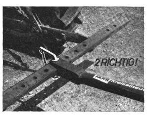
Ein kleiner Kniff, der keine Mehrarbeit erfordert! Die Sicherung kann nicht verloren gehen, die lästige Suche nach einem Stück Draht entfällt und die angehängten Landmaschinen sind immer vorschriftsmässig gesichert!
