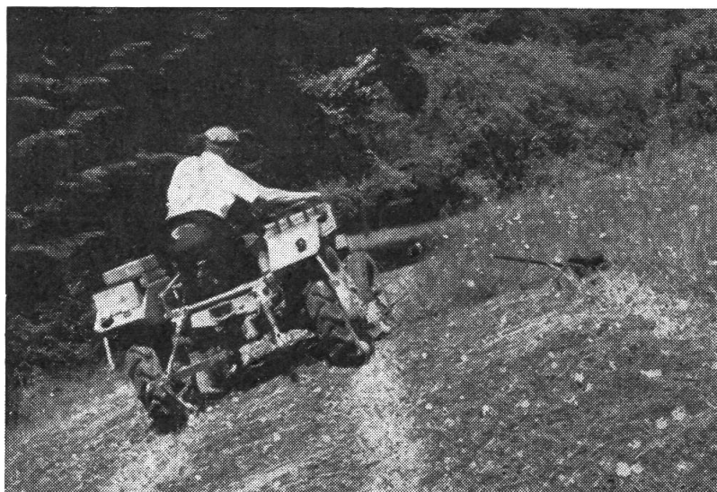
Abb. 4: Mähen mit einem Leichttraktor auf einer Wiese bis zu 42‰ Neigung. Eine entsprechende Unebenheit in der Wiese genügt, um den Traktor zum Kippen zu bringen.
