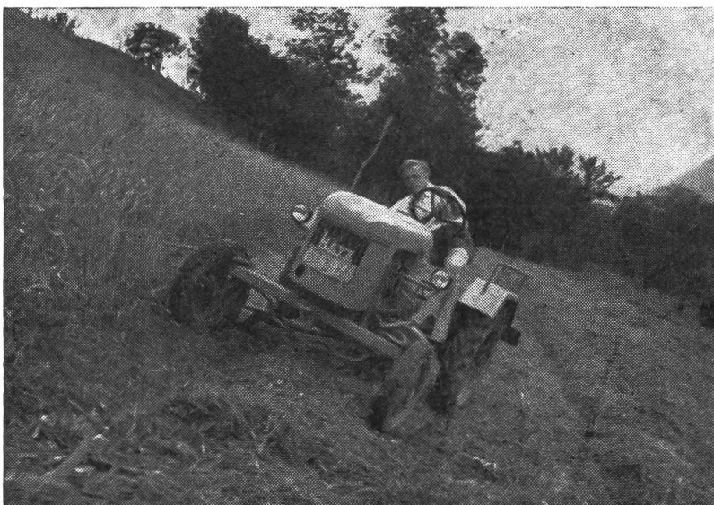
Abb. 3: Hier ist bereits deutlich das Abgleiten der Hinter- räder zu beobachten (Hangneigung im Durch- schnitt 40 %).
