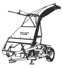
Hochdruck-Sammelpresse 214 B/D für Heu und Stroh. Aufnahmebreite 1,60 m, Stundenleistungen: Stroh 7 Tonnen, Heu 9 Tonnen.
