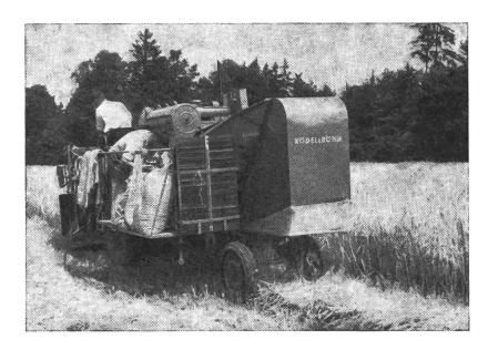
Abb. 1: Selbstfahrender Mähdrescher mit Absackstand
