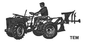
Dank technischer Reife und Bewährung bietet «MT-TEM-TTA» viel mehr als sie kostet Einige ihrer Vorteile: Schweizer Motoren MAG 11/12 PS: Benzin oder Diesel; Ritzelgetriebe: 9 Vorwärts- und 3 Rückwärtsgänge, echter Kriechgang, Differentialsperren und Freiläufe in Vorderachse und Hinterachse, abschaltbare Zapfwellen: gangabhängig und gangunabhängig, wirksame Vierradbremsen.
