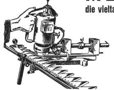
Für jeden Betrieb das passende Modell. 220 u. 380 Volt, Motor 1/4 u. 1/3 PS. Zusatzgeräte zum Schleifen von Häcksler- und Feldhäckslermessern.
