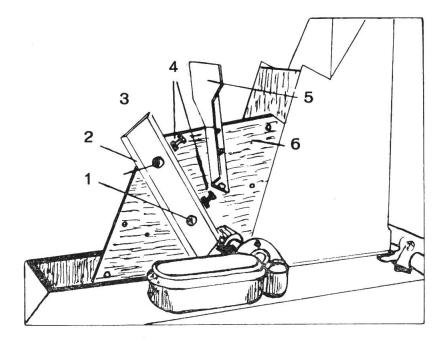
Bild 2: Sechseckiges Messerrad im Radkasten
