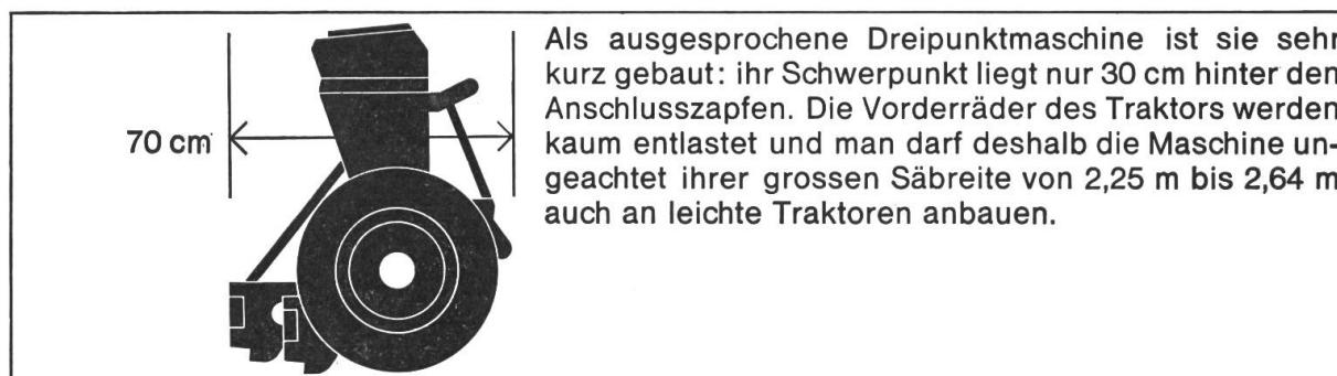
Als ausgesprochene Dreipunktmaschine ist sie sehr kurz gebaut: ihr Schwerpunkt liegt nur 30 cm hinter den Anschlusszapfen. Die Vorderräder des Traktors werden kaum entlastet und man darf deshalb die Maschine ungeachtet ihrer grossen Säbreite von 2,25 m bis 2,64 m auch an leichte Traktoren anbauen.
