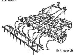
Zur Bearbeitung der Stoppelfelder, Kartoffelfelder sowie zur Unkrautbekämpfung, Saatbeetbereitung usw. nur die
