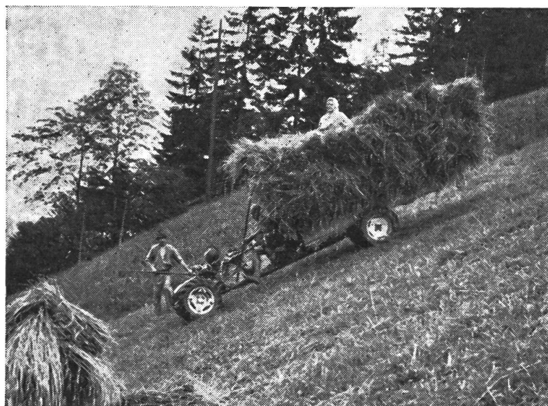
Abb. 8 Der Benzin-Einachstraktor beim Einfahren von Getreide auf Feldern mit Hangneigungen bis max. 55 Prozent.
