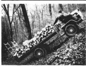
Mit dem Seilzug und Vierradantrieb im Gleichlauf ist kein Hang zu steil
