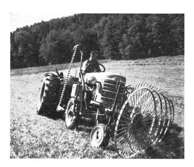
Wer Hanggelände zu befahren hat, sehe deshalb vor, bereits beim Kauf Traktortypen zu berücksichtigen, die diesem Gelände gut angepasst sind, d.h. solche mit niederer Schwerpunktlage. Durch Verbreiterung der Spurweite und Doppelbereifung kann zudem die Bodenhaltung von Motorfahrzeugen wesentlich verbessert werden.
